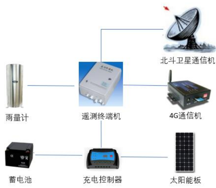
雨量遥测站结构图
